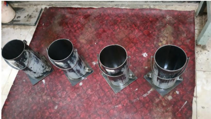
*Moldes para realizar las probetas*
