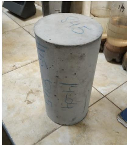
*Probeta de hormigón*
