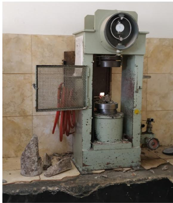
*Máquina universal de ensayos de probetas a compresión*
