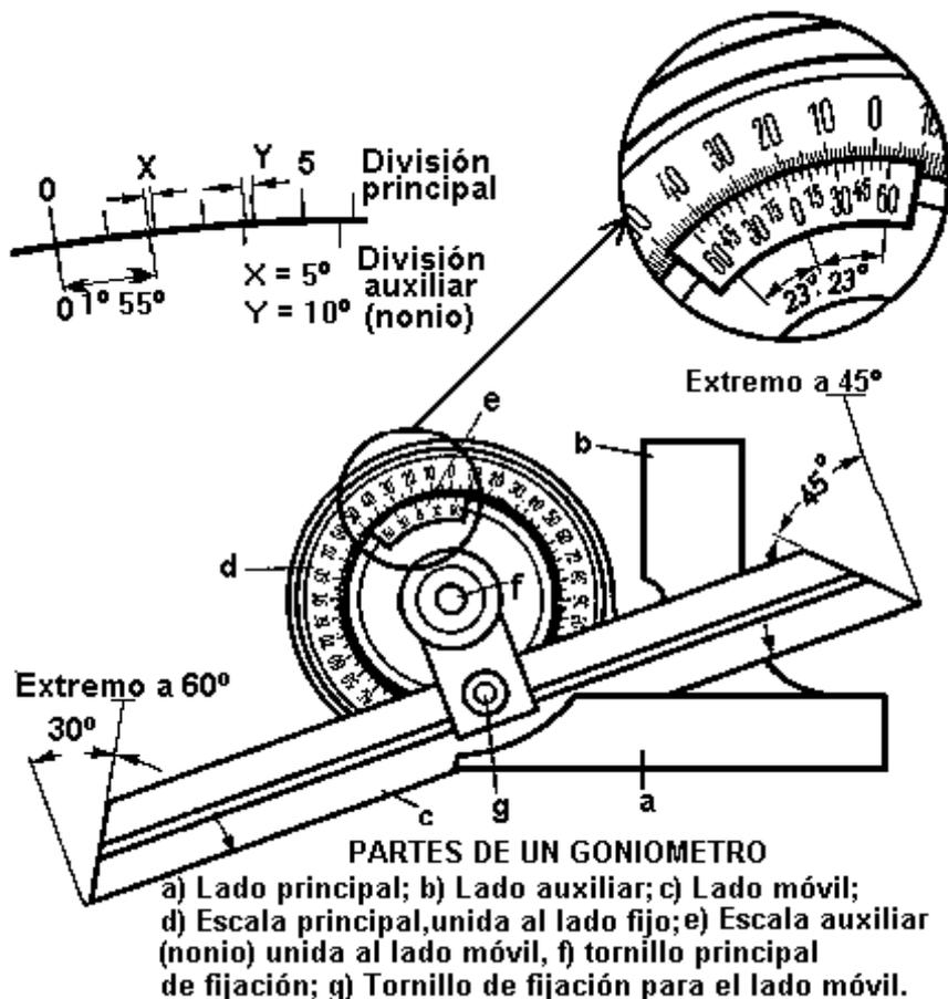
Es importante tener en cuenta que el goniómetro mide los ángulos entre sus propias partes, por lo que la exactitud de la medición dependerá de la precisión del contacto de las superficies del ángulo con las partes del goniómetro.
