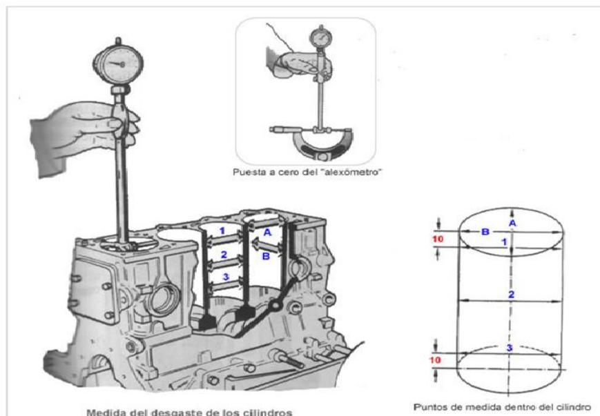
Una vez realizadas las mediciones podremos apreciar con los valores obtenidos los puntos (1, 2, 3) si el cilindro está cónico, y comparando los datos obtenidos en las mediciones realizadas en los sentidos A y B, podemos saber si el cilindro está ovalado.
