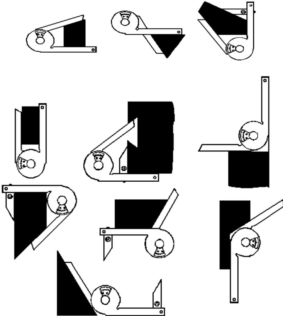
En el ejemplo siguiente vemos el uso del goniómetro montado sobre un calibre de altura.
