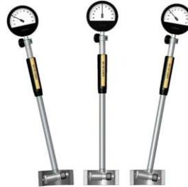
El funcionamiento interno del alesámetro es el siguiente: al ejercer una presión sobre la varilla intercambiable hay un desplazamiento de la punta, esta transmite el movimiento a la barra opresora a través de una leva (a,b,d) o de un plano inclinado con una bolilla de acero (c). Luego la barra opresora desplaza el husillo del comparador y la aguja del mismo gira en la escala graduada; en centésimas o en milésimas de acuerdo a la necesidad; donde efectuaremos la lectura.
