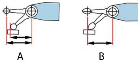
Si usamos este instrumento en combinación con un calibre de altura para tomar diferencias de niveles en una pieza, no tendremos los problemas antes citados, puesto que el palpador no será utilizado para efectuar lecturas, sino como referencia del cero de medición y las lecturas se harán en el vernier del calibre de altura.
