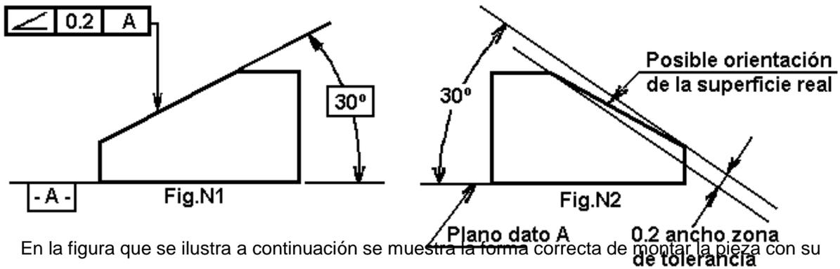
En la figura que se ilustra a continuación se muestra la forma correcta de montar la pieza con su plano dato "A" sobre la cara de apoyo de la regla de senos y desplazando un palpador sobre la cara a controlar, el error máximo leído en el no debe exceder la tolerancia de angularidad especificada de 0.2 mm.
