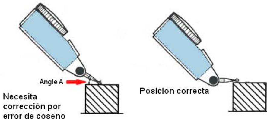
Este error tiene mucha importancia en el momento de efectuar controles de perpendicularidad, paralelismo, planitud, concentricidad, etc., pues estas condiciones geométricas suelen tener valores de tolerancia muy pequeños y si por ejemplo el ángulo  $\theta$  es igual a  $30^\circ$  estamos cometiendo un error de aproximadamente 0,01 mm.
