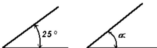
La unidad de medición angular en el SI, es el radian, pero permite usar la unidad llamada grado, la cual es más comúnmente usada en la Industria.
