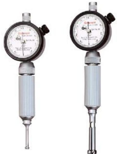
Este instrumento viene en distintos rangos de medición; 6 a 10 - 10 a 18,5 - 18 a 35 - 35 a 60 - 50 a 100 - 100 a 160 - 160 a 250 - 250 a 400 mm
