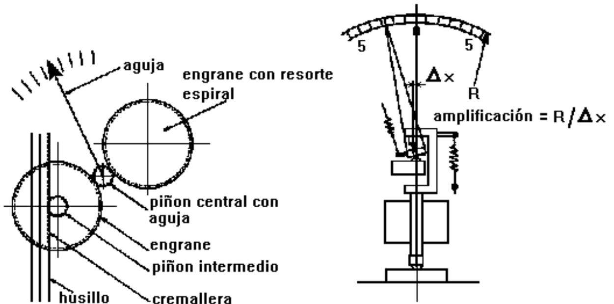
En los primeros comparadores utilizados por la Industria como instrumental de medición desde principios del siglo XIX, la amplificación del desplazamiento se logró mediante una palanca. El mínimetro de Hirth, fabricado en 1907, fue el primer comparador cuyas partes fueron semejantes a las que conforman los actuales comparadores. Este instrumento tenía una estructura simple e incluía únicamente una palanca y solo una etapa de amplificación, tal como se indica en la figura anterior.
