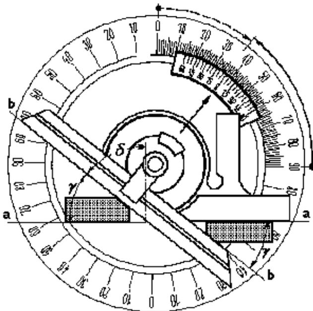
Colocación de Goniómetro y posición de partida al medir: a) Canto de aplicación del lado fijo; b) canto de aplicación del lado móvil. lectura  $\gamma$ : posición de partida  $0^{\circ}$ , hacia la derecha  $\gamma = 37^{\circ} 20'$ . Lectura  $\delta$ : posición partida  $90^{\circ}$  hacia la izquierda,  $\delta = 52^{\circ} 40'$  (contando a partir de  $90^{\circ}$ ).
