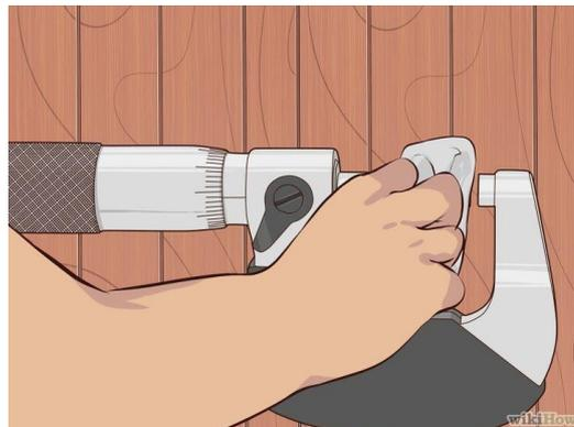
9. Cuando se almacene un micrómetro por largos periodos o necesite lubricación, use un trapo humedecido con un líquido que prevenga la oxidación para untar cada componente del micrómetro. Asegúrese que el aceite esté repartido uniformemente sobre las diferentes partes.
