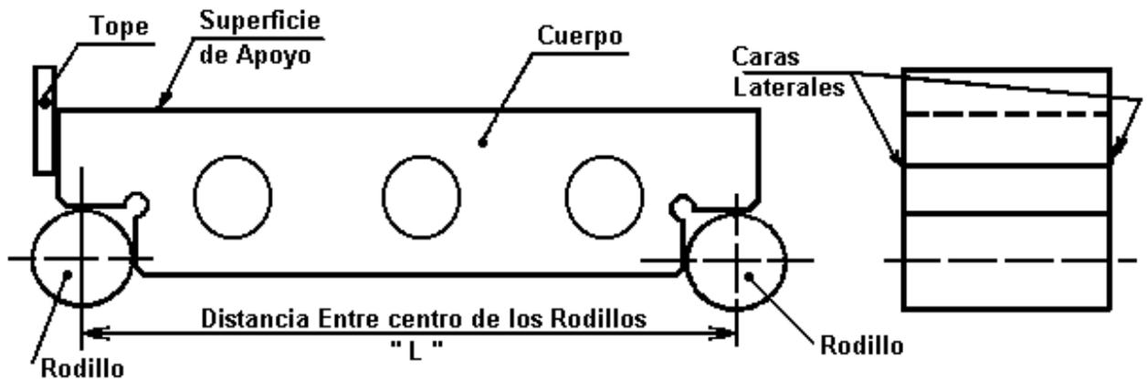
Para realizar mediciones se requiere colocar la regla de senos en un mármol o plano de referencia con los rodillos apoyados sobre el mismo.
