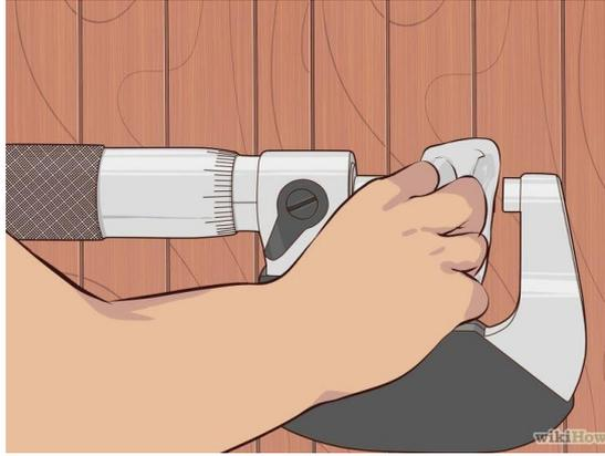
4. Deje el micrómetro y la pieza para medir en un cuarto el tiempo suficiente para estabilizar la temperatura. Una barra de hierro de longitud 1000mm cambiará 0.012 mm (12 micrones) con un cambio de temperatura de 1° C.
