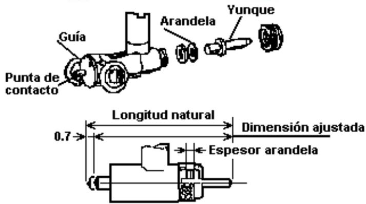
6. Monte y asegure adecuadamente el comparador. Ajuste la profundidad del comparador mientras observa la posición de la aguja indicadora.
