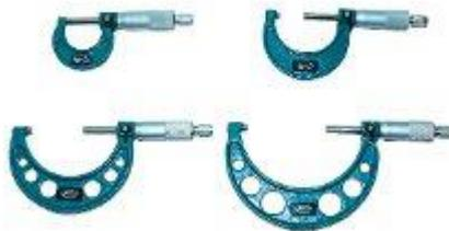
2. No aplique excesiva fuerza al micrómetro. No lo deje caer y evite que reciba golpes. No gire el micrómetro violentamente.
