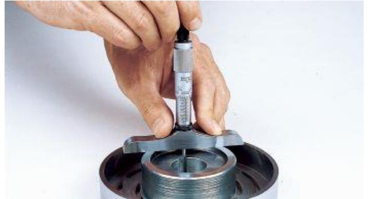
7. Cuando monte el micrómetro sobre un soporte, asegúrese de que el cuerpo del micrómetro esté sujeto al centro y que la sujeción no haya sido muy fuerte.
