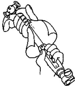
5. Ajuste el punto cero (punto neutral) del alesámetro, incrementos de 0,5 mm aproximadamente, al centro del rango de medición del alesámetro.
