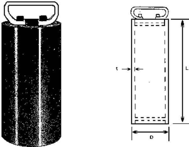
También pueden hacerse mediciones comparativas contra un patrón de perpendicularidad, comúnmente llamado cilindro de perpendicularidad o escuadra cilíndrica, su tolerancia de  $\perp$  es de  $3 \mu\text{m}$  (3 micrones) cada 250 mm, este elemento es muy usado en los laboratorios de metrología para el control de escuadras, el mismo se ve en la figura siguiente.
