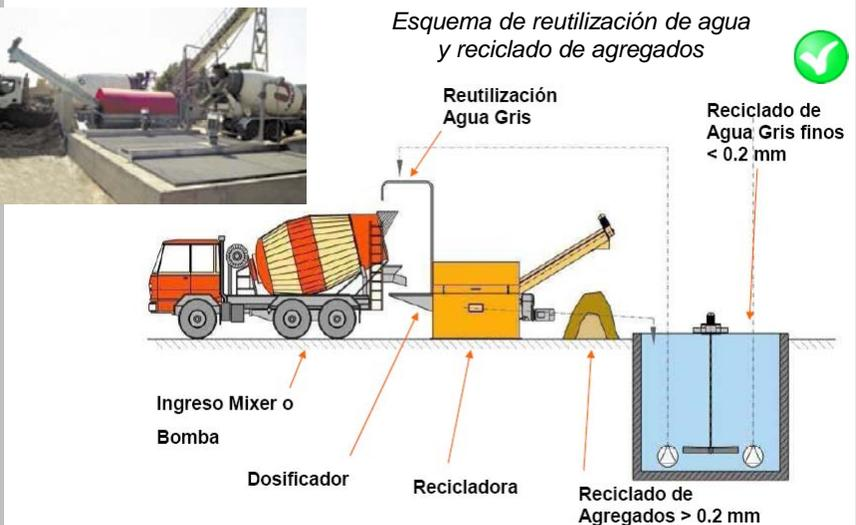
Ingreso Mixer o Bomba      Dosificador      Recicladora      Reciclado de Agregados > 0.2 mm
