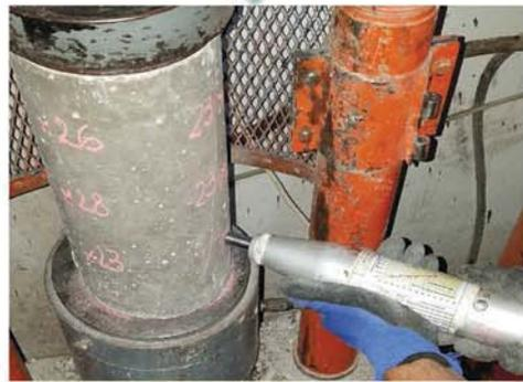
Calibración mediante 9 puntos en probetas 15x30.
