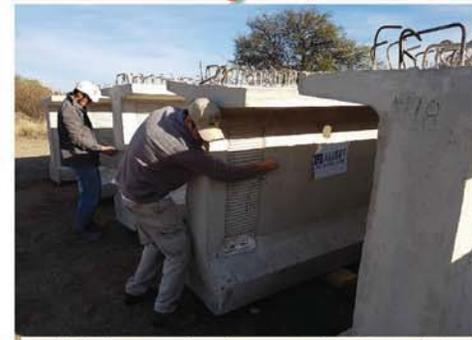
Medición precisa de ancho con pie de rey (izquierda) de elemento y ensayos sobre vigas de puentes (derecha).
