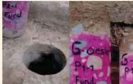
➤ Ensayo de aspersión de fenolftaleína inmediatamente después de la extracción.
