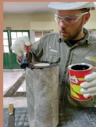
^ Sellado de la superficie circundante a la zona escarificada con el recubrimiento impermeabilizante.
