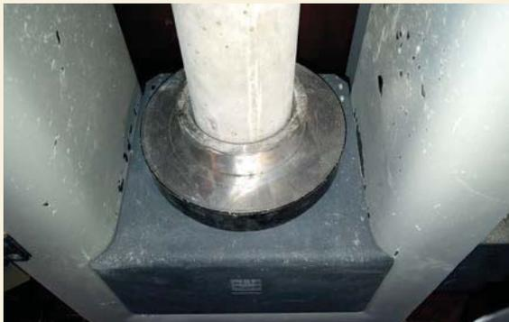
5 - CENTRADO DEL RETÉN METÁLICO DEL ENCABEZADO CON MARCAS CONCÉNTRICAS DE LA PRENSA.
