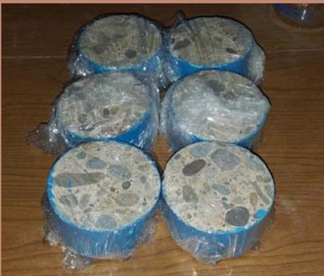
^ Se ensayan tres probetas por cada muestra.
