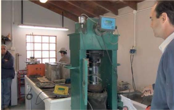
1 - CALIBRACIÓN DE PRENSA MANUAL CON DISPLAY DIGITAL.
