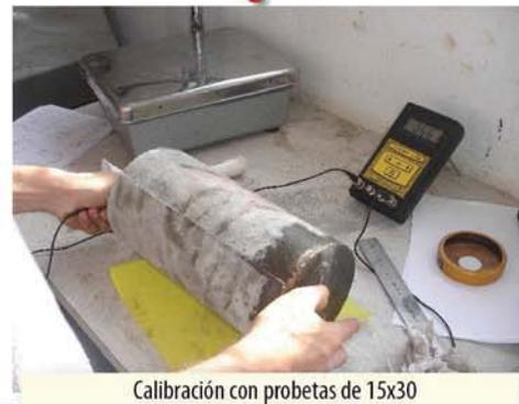
Calibración con probetas de 15x30 que luego son encabezadas y ensayadas a compresión.
