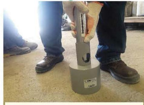
Yunque digital de puesta a cero del esclerómetro.
