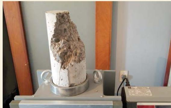
6 - ROTURA DE PROBETA TIPO 4 SEGÚN IRAM 1524.
