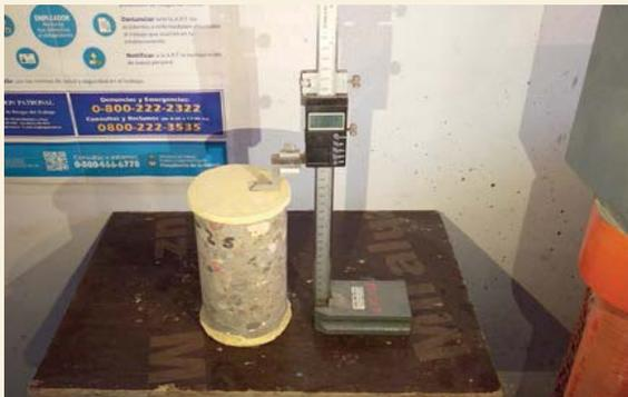
3 - MEDICIÓN DE ALTURA CON ENCABEZADO (RELEVANTE PARA TESTIGOS DE HORMIGÓN).
