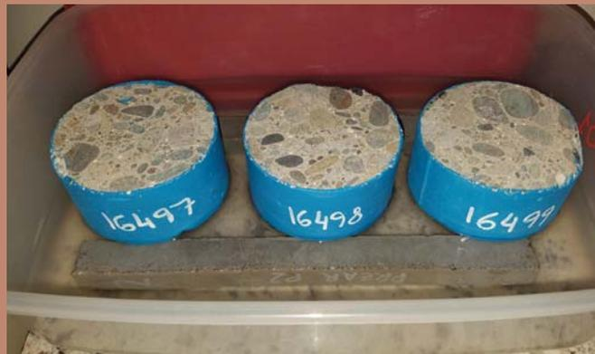
^ Colocación de probetas con 3 mm de agua y accesibilidad libre por su cara inferior.
