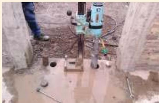
➤ Extracción de dos testigos con la misma fijación (muy recomendable).
