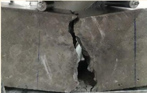
7 - APRECIACION DE ROTURA DENTRO DEL TERCIO MEDIO PARA VALIDAR EL ENSAYO.
