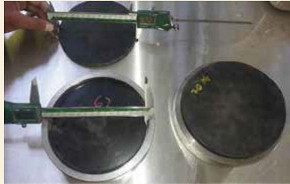
Los discos de neopreno deben ser compatibles con el diámetro de los retenes (izquierda) y no ingresar a presión (derecha).
