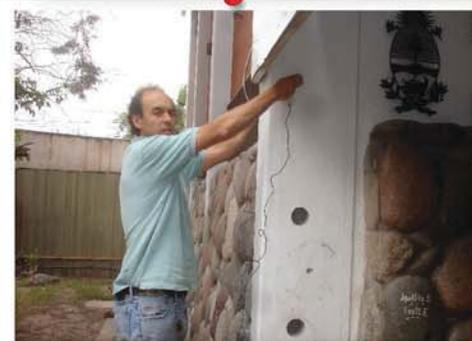
Ensayos de ultrasonido para correlacionar valores con testigos ya extraídos.
