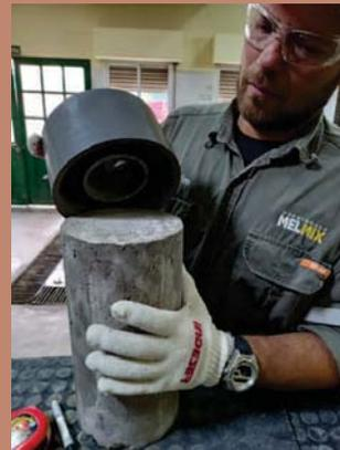
^ Escarificado de probeta en la zona de ensayo luego de desmoldarse.
