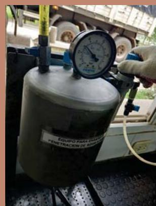
^ Ajuste de la presión de agua para cumplir la secuencia y el tiempo de mantenimiento durante el ensayo.
