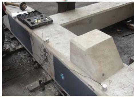
Ejemplo de transmisión superficial de ensayo de ultrasonido.
