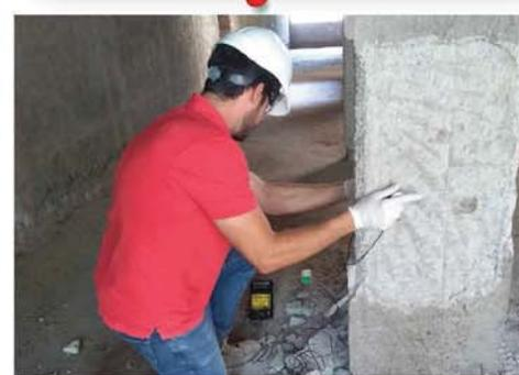
Ultrasonido en columna para estimar resistencias mediante una calibración previa con testigos.
