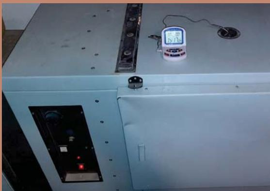
Secado en un horno de convección específico a 50 °C hasta lograr variaciones de masa iguales a 0,1% (esta tarea es crítica).
