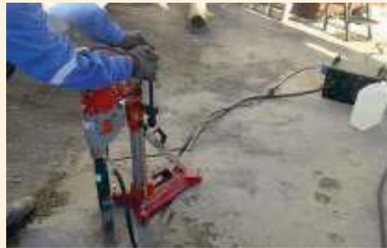
➤ Máquina con burlete y bomba de vacío (ahorro de tiempo en fijación)
