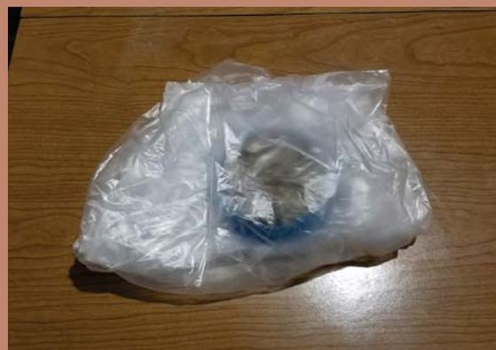
Envoltorio en plástico para que las probetas no ganen humedad y puedan enfriarse.
