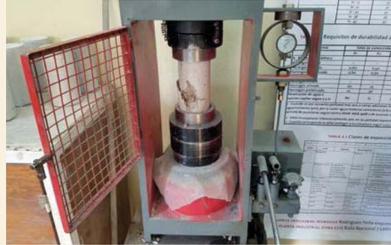
2 - PRENSA MANUAL CON ARO DINAMOMÉTRICO.
