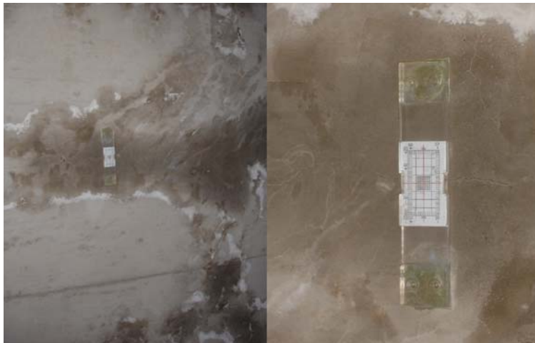
▲ Figura 5. Testigos comparadores para seguimiento cuantitativo de grandes movimientos
