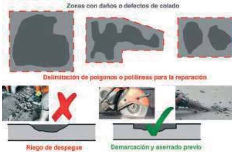
➔ FIGURA 2 – DELIMITACIÓN DE DEFECTOS
