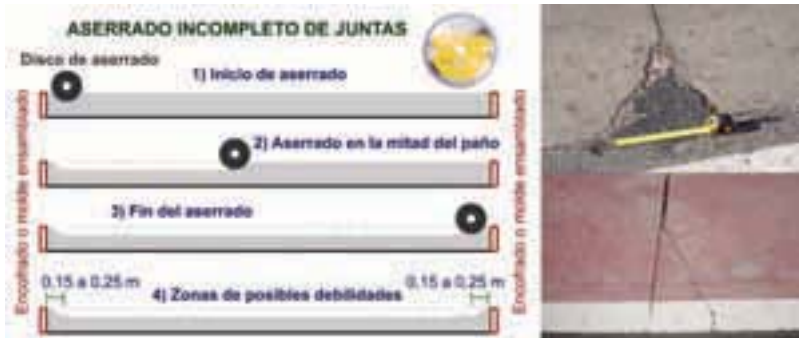
4 Fisuras de esquina por aserrado incompleto
