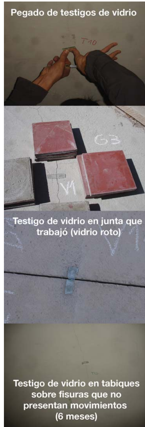
▲ Figura 4. Testigos de vidrio para seguimiento cualitativo
