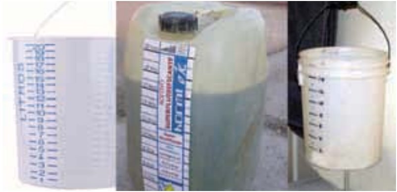
Figura 2 - Baldes y bidones graduados para la incorporación precisa de aditivos en obra
