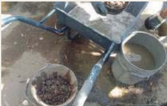
↗ Tamizado hasta obtener el agregado grueso (eliminando el mortero)
