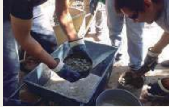
↗ Pasaje del hormigón del recipiente del PUV al tamiz
