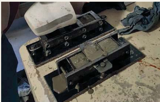
⤴ Moldeo para una consistencia muy fluida
