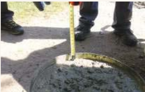
Espacio superior libre necesario en el ensayo de exudación (no se enrasa convencionalmente).
