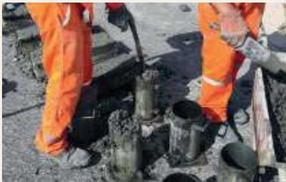
↗ Vibrado en dos capas de probetas de 15 x 30 cm
