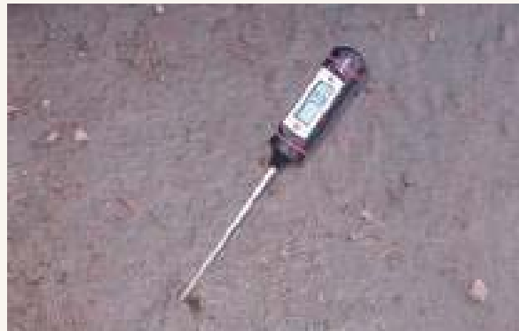
Temperatura del hormigón en tiempo frío sin protección
