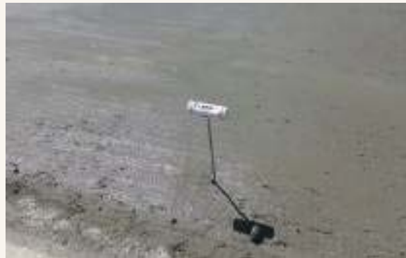
Medición de temperatura en pavimentos ya colados
