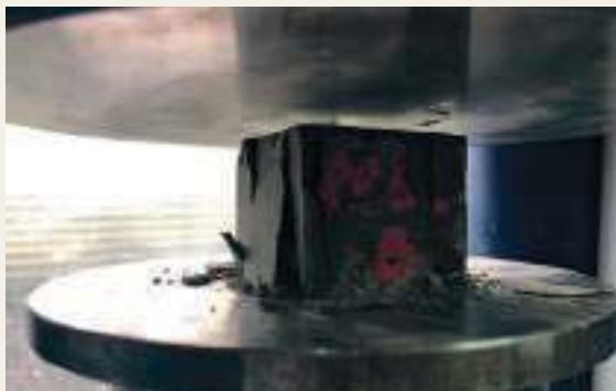
⤴ Rotura de probeta cúbica de material de reparación.
