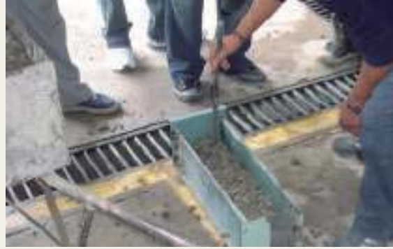
⤴ Varillado del hormigón de la primera capa (no recomendable para Asentamiento menor a 7 cm)
