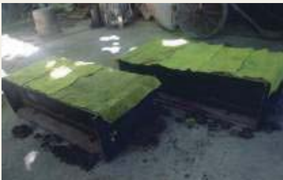
⤴ Protección con paños húmedos después del colado y hasta el desmolde de las probetas
