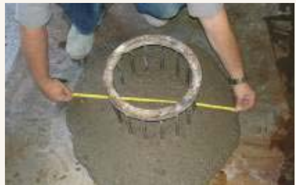
Ensayo de extendido de J-Ring
