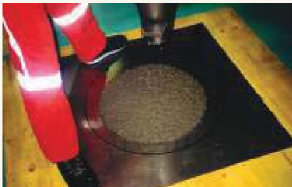
Extendido libre y T50 (durante el ensayo)
