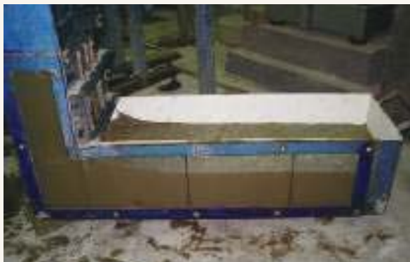
Vista lateral del ensayo en la Caja en L
