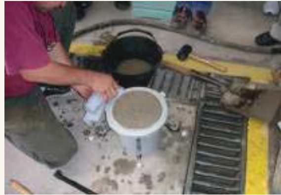
⤴ Limpieza con trapo húmedo de la parte de contacto con la tapa
