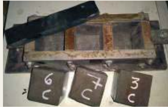
⤴ Molde para tres probetas cúbicas de 50 mm y pisón de neopreno para compactar mezclas secas y plásticas
