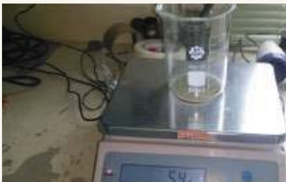
Pesaje (opcional a medición por volumen) del agua de exudación a diferentes intervalos.
