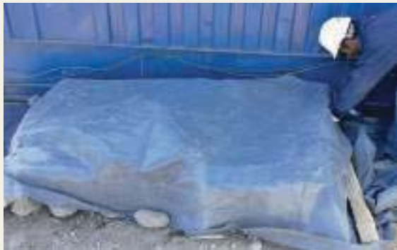
↗ Tapado con material aislante de probetas durante las primeras 24 horas
