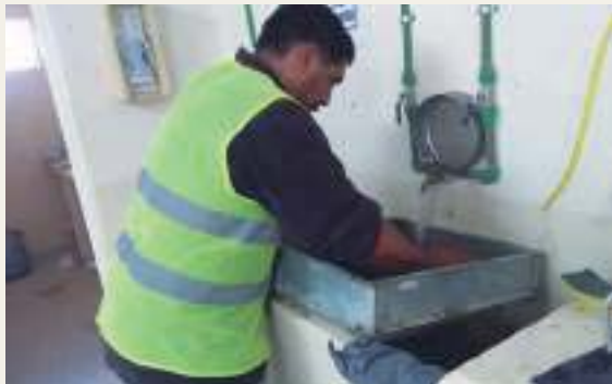
↗ Lavado del agregado sobre cribas industriales
