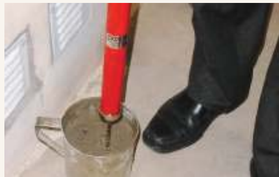
➤ Penetraciones con aguja de menor sección.
