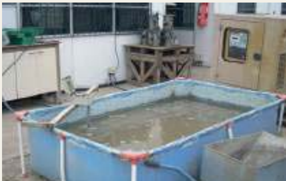
↗ Curado probetas en pileta a temperatura controlada
