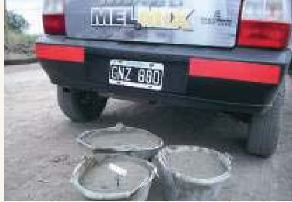
Medición de temperatura en obra en moldeo remoto
