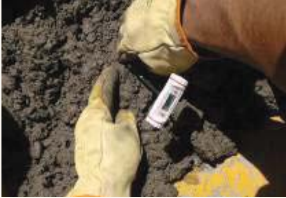
Medición de temperatura en carretilla apisonando a los costados del pinche
