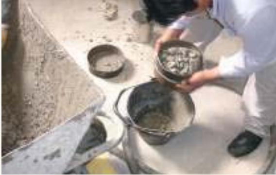
➤ Tamizado del hormigón fresco.
