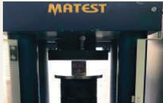
⤴ Bastidor de prensa calibrada a baja carga para ensayo de grout
