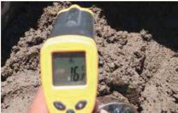
Medición de temperatura con termómetro infrarrojo
