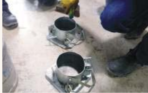
➤ Moldes para dos ensayos de tiempos de fragüe en paralelo.
