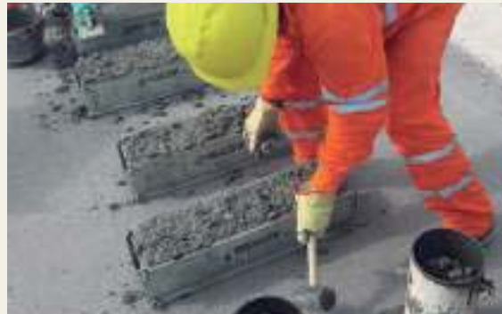
⤴ Golpes con martillo de goma después de consolidar cada capa y tareas de enrasado de probetas
