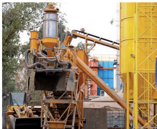
◀ F. 7 bis: Sistema de captura de polvo en punto de carga
