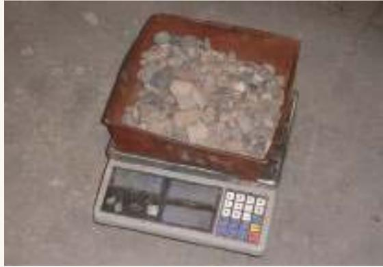
➤ Pesado de muestra de ensayo seca
