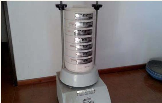
➤ Tamizadora automática (siempre después realizar verificación manual)
