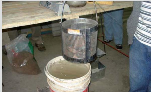
↘ Retiro del cesto del agua después de las pesadas
