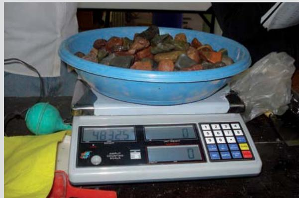
↘ Pesaje del agregado grueso en condición SSS
