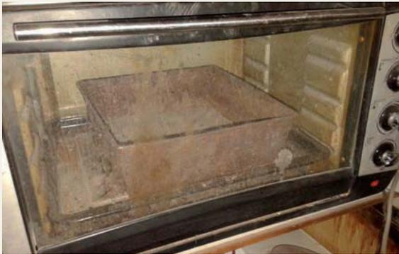
Secado de AF a masa constante después del lavado (IRAM 1540)
