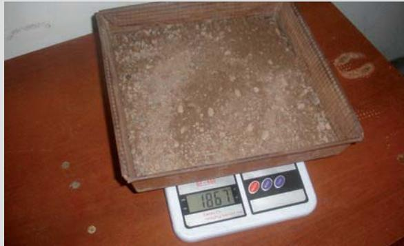
↗ Balanza común de 1g para el peso húmedo de arenas
