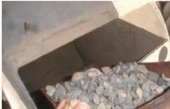
➤ Carga de agregado de la máquina de Los Ángeles
