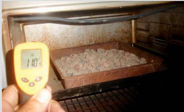
↗ Secado en horno con temperatura controlada
