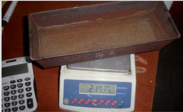
↗ Balanza de precisión 0,1 g con tara de bandeja
