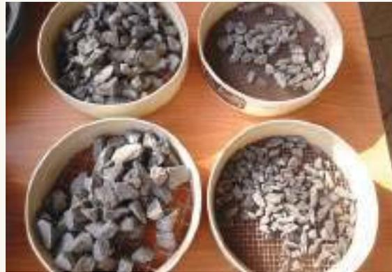
Separación del agregado por fracciones granulométricas
