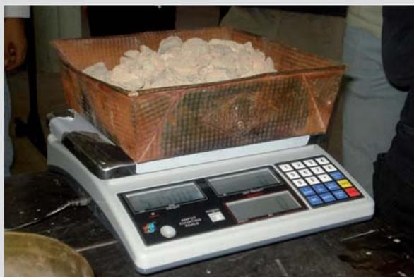
↗ Peso seco en balanza para agregados gruesos de 5 g
