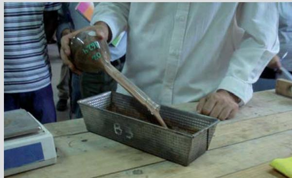
➤ Vertido de muestra en bandeja y secado a masa constante
