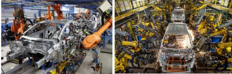
Figura 8: Armado y soldadura de carrocería
