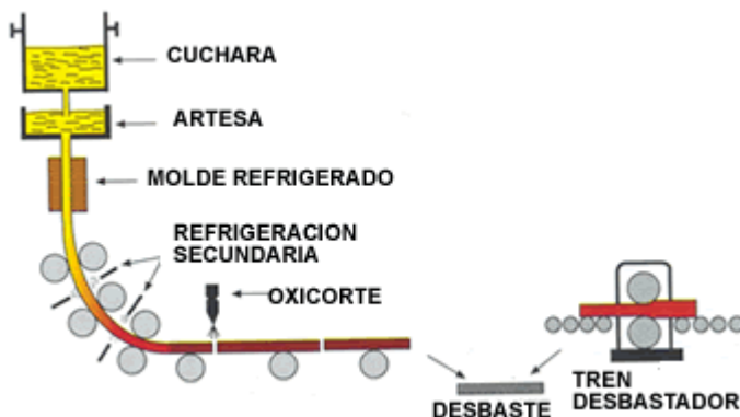
Fig.13 esquema de un sistema de colada continua
