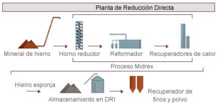
Fig.6 Flujos de proceso de reducción directa
