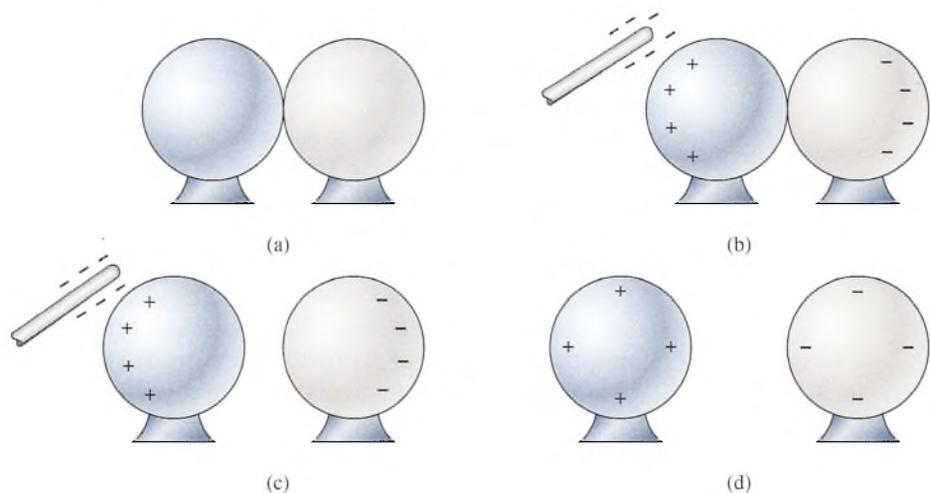
**Figura 23.11** Carga de dos esferas metálicas por inducción.
