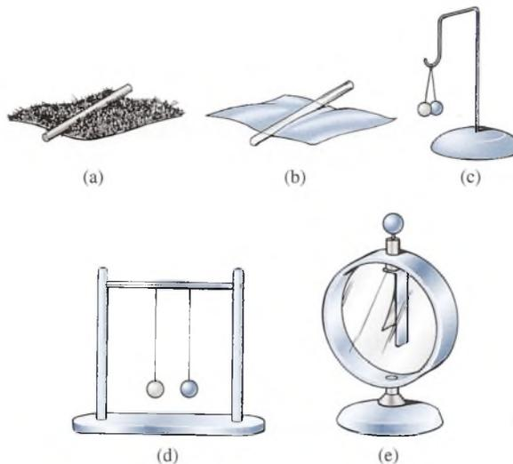
**Figura 23.1** Materiales de laboratorio para estudiar la electrostática: (a) una barra de ebonita descansa sobre un trozo de piel de gato, (b) una barra de vidrio descansa sobre un pedazo de seda, (c) el electroscopio de esferas de médula de saúco, (d) dos esferas de médula de saúco suspendidas y (e) el electroscopio de hoja de oro.
