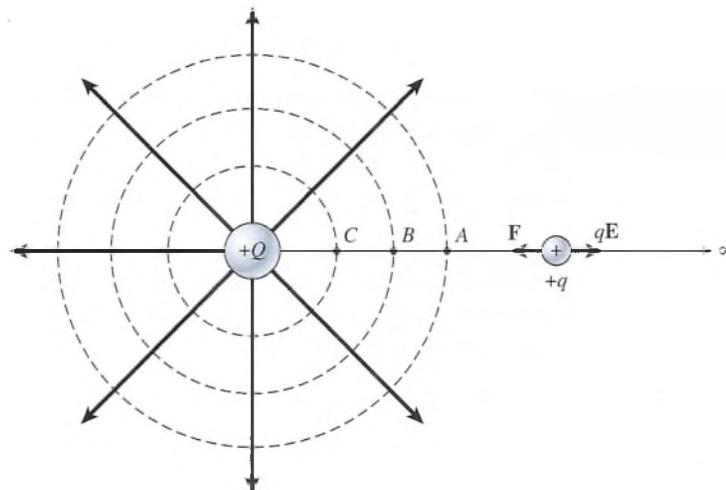
**Figura 25.5** La energía potencial debida a una carga colocada en un campo eléctrico es igual al trabajo realizado *contra* las fuerzas eléctricas que transportan la carga desde el infinito hasta el punto en cuestión.
