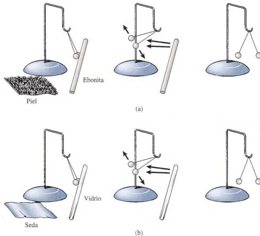
**Figura 23.2** (a) Cómo proporcionar carga a un electroscopio de esferas de médula de saúco con una barra de ebonita. (b) Cómo proporcionar carga a las esferas de médula de saúco con una barra de vidrio.
