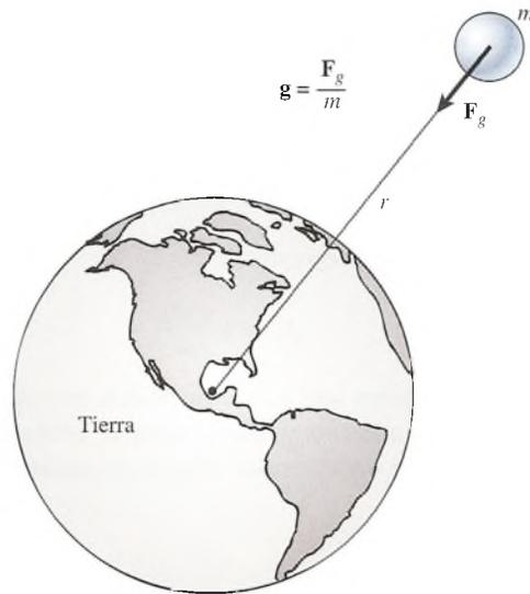
**Figura 24.1** El campo gravitacional en cualquier punto sobre la Tierra puede representarse mediante la aceleración  $\mathbf{g}$  que una pequeña masa  $m$  experimentaría si nos colocáramos en ese punto.
