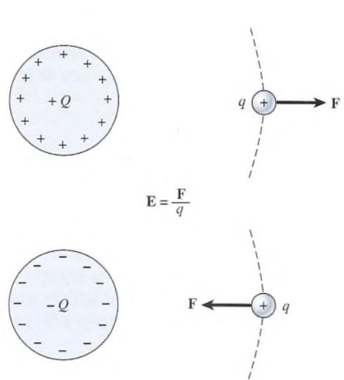
**Figura 24.2** La dirección de la intensidad del campo eléctrico en un punto es la misma que la dirección en que una carga positiva  $+q$  se movería cuando fuera colocada en ese punto. Su magnitud es la fuerza por unidad de carga ( $F/q$ ).
