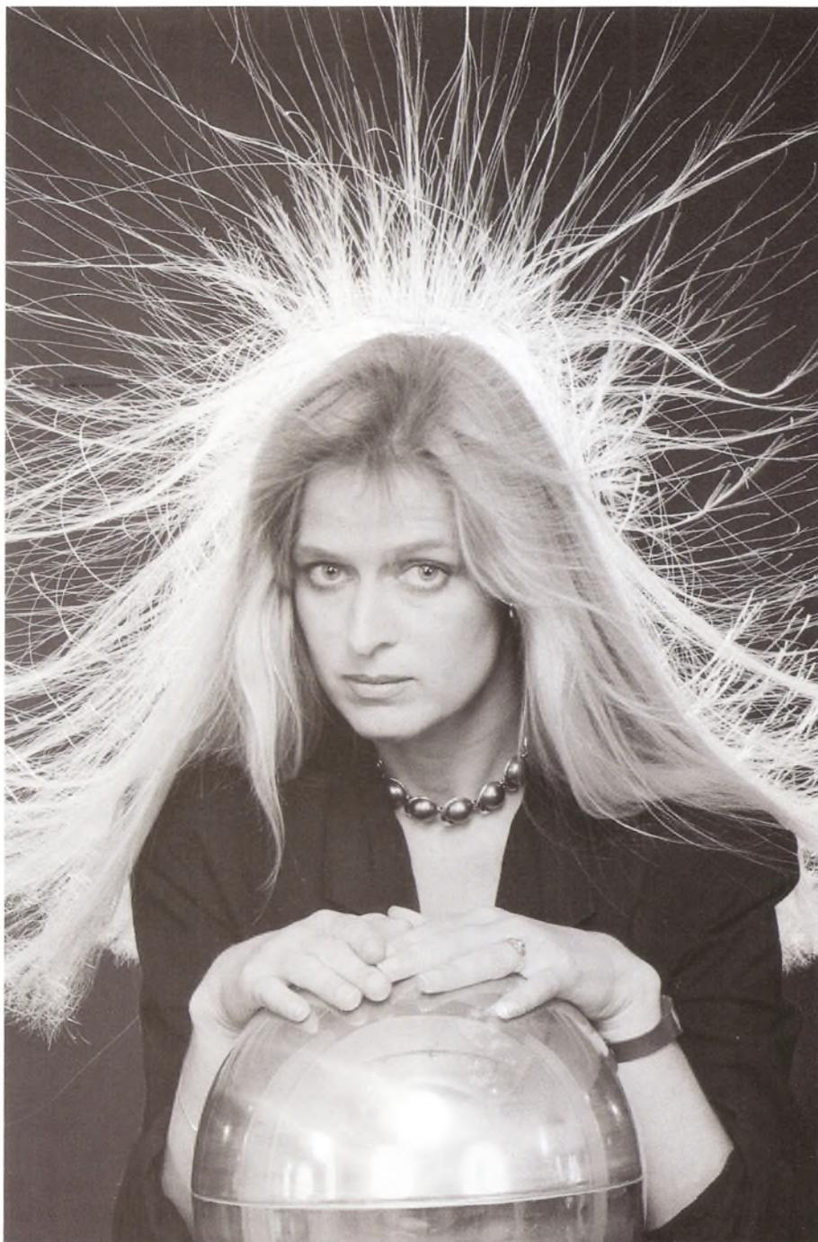
Los generadores electrostáticos, como el generador de Van de Graff mostrado aquí, pueden transferir cantidades enormes de carga a un domo de plata. Estos dispositivos producen voltajes altísimos. La repulsión electrostática produce este efecto sorprendente en el cabello de la mujer.
