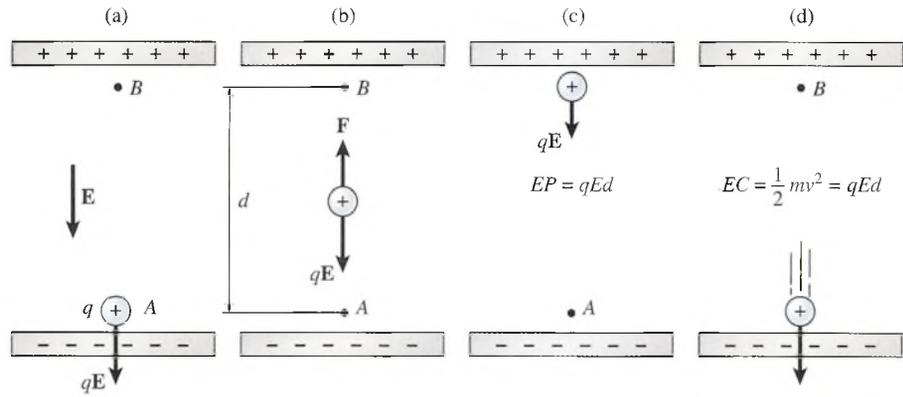
**Figura 25.2** Una carga positiva  $+q$  se desplaza en contra de un campo eléctrico constante  $\mathbf{E}$  a través de una distancia  $d$ . En el punto  $B$  la energía potencial será  $qEd$  con respecto al punto  $A$ . Cuando se suelta, la carga ganará una cantidad equivalente de energía cinética.
