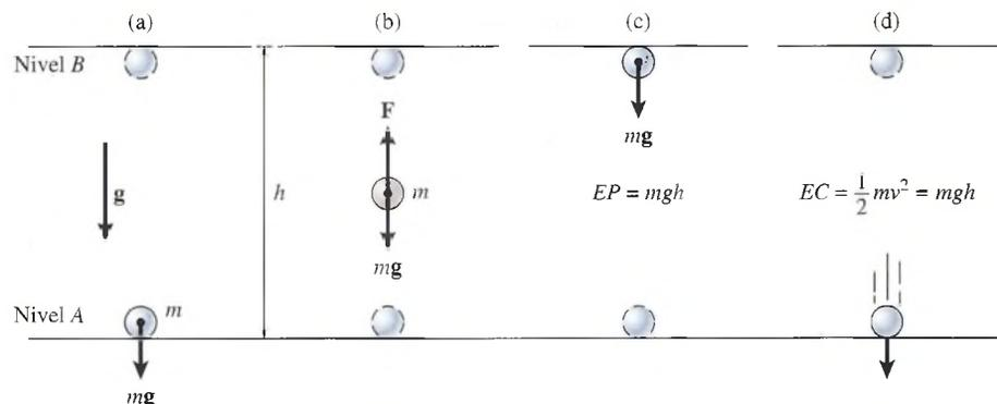
**Figura 25.1** Una masa  $m$  se eleva contra el campo gravitacional  $g$ , lo que da por resultado una energía  $mgh$  en el nivel B. Cuando se suelta la masa, esta energía se transformará totalmente en energía cinética al ir cayendo hacia el nivel A.
