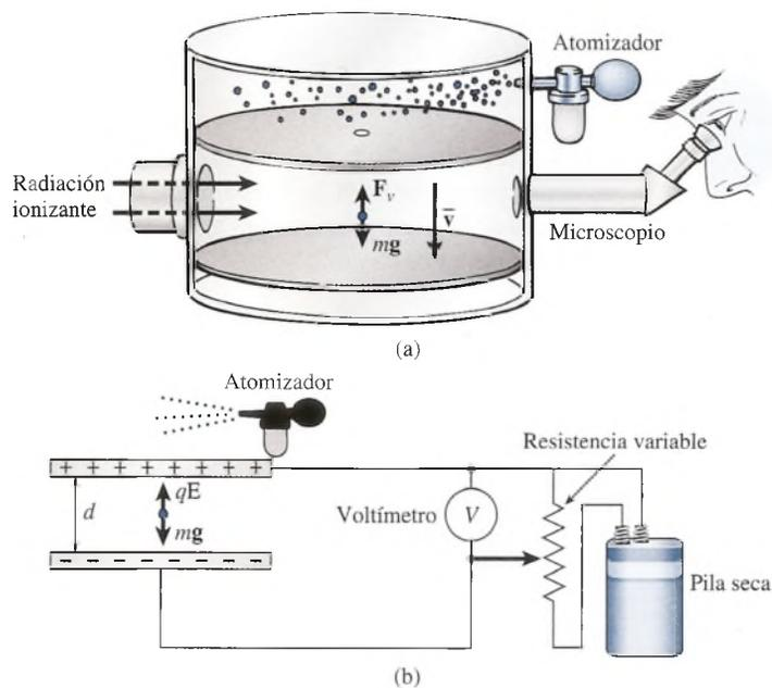
**Figura 25.10** Experimento de Millikan de la gota de aceite: (a) La masa  $m$  de la gota se determina a partir de su velocidad de caída, en contra de la fuerza viscosa de la resistencia del aire. (b) La magnitud de la carga se puede calcular partiendo de las condiciones de equilibrio que mantienen suspendida la carga entre dos placas con carga opuesta (véase la figura 25.10).
