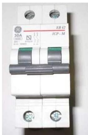
El Interruptor de Control de Potencia (también llamado ICP o limitador) es un interruptor que instala la compañía eléctrica. Sirve para limitar el consumo de energía del cliente a la potencia que se ha contratado. Se conecta a los conductores que llegan de la Derivación Individual, de forma que si la potencia consumida por los aparatos eléctricos conectados en la vivienda es superior a la contratada, interrumpe el suministro.
