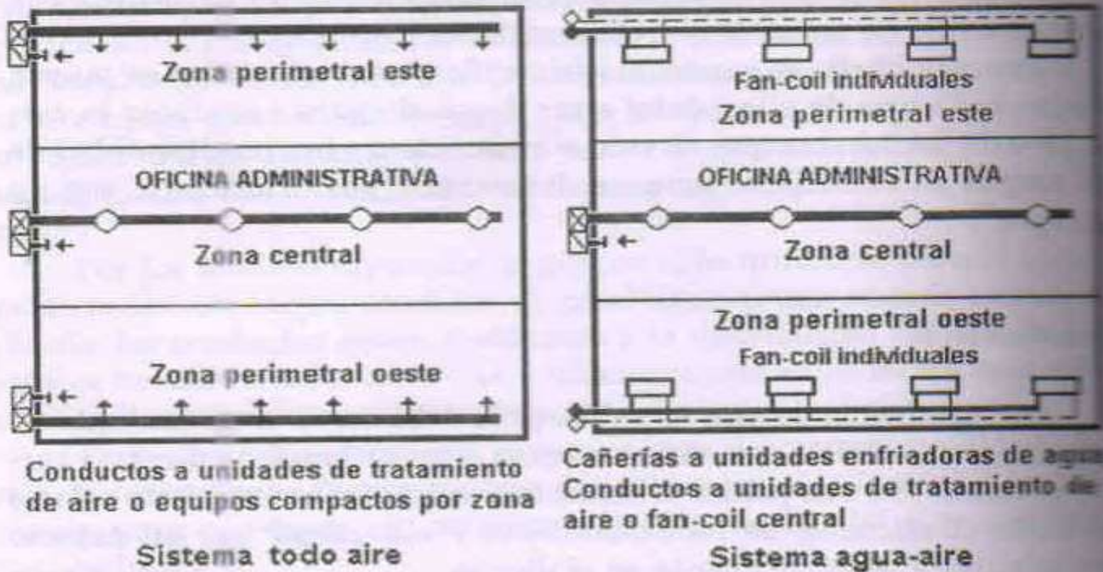
Figura 2-V. Zonificación por orientación de las paredes exteriores.
