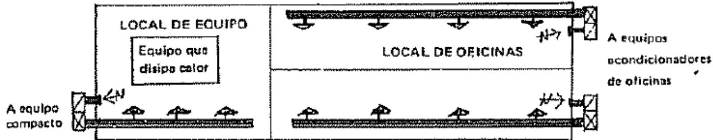
FIG. 6-IV. Zonificación por cargas internas variables.
