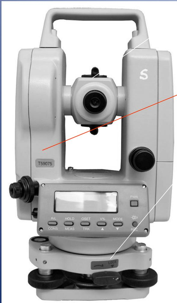
Instrumento a anteojo astronómico que permite visualizar puntos del terreno e indicar las direcciones (ángulos) en que ellos se encuentran
