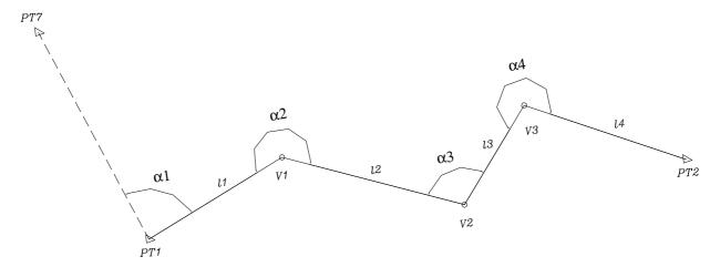
De esta manera tendremos, aparte de control lineal, los lados de la poligonal con acimuts referidos al sistema de los puntos fijos.
