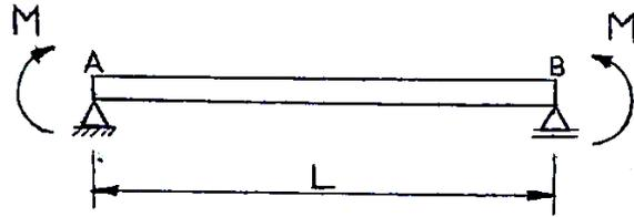
Recordando la definición de la curvatura  $\kappa = \frac{1}{\rho} = \frac{M}{EI}$ , las relaciones de la curvatura con la Tasa de Cambio de Giro  $d\theta/dx$  y con la tasa de cambio de los desplazamientos perpendiculares al eje de la pieza  $dv/dx$ ,  $\kappa = \frac{d\theta}{dx}$  ;  $\theta = \frac{dv}{dx}$ , relacionando dichas ecuaciones resulta:
