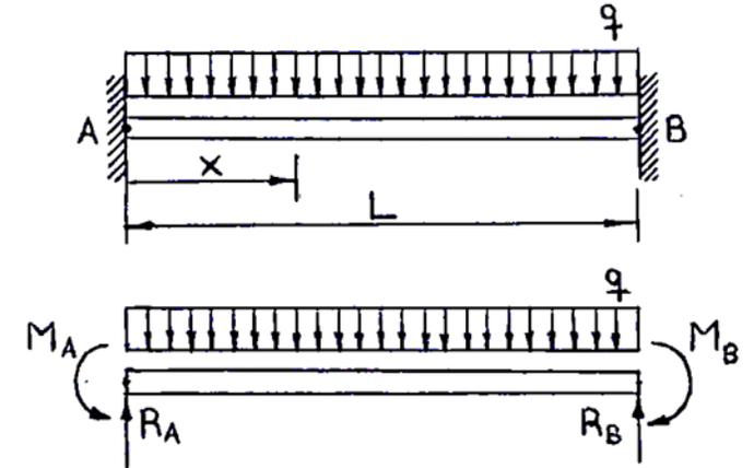
Aplicando la condición de contorno  $\theta_{(0)} = 0$ , se obtiene  $C_1 = 0$  y así:
