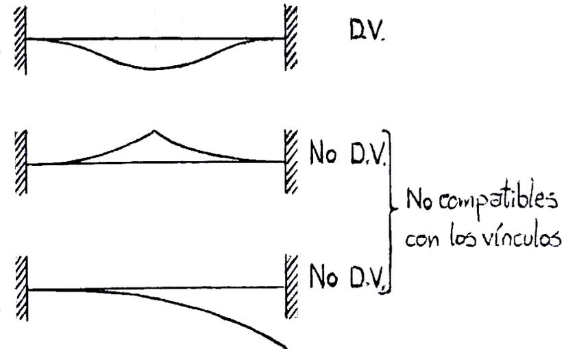
La Deformación Virtual es arbitraria, puede ser una deformación real de la estructura u otra de interés. Luego es independiente de la carga.
