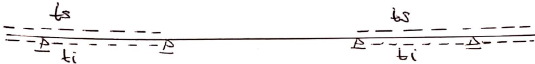
Las flexibilidades ya se calcularon en el Problema 3. Los términos de carga debidos a las acciones térmicas se obtienen por TTV. En la figura inferior se muestra la elástica debido a la temperatura en el SF.
