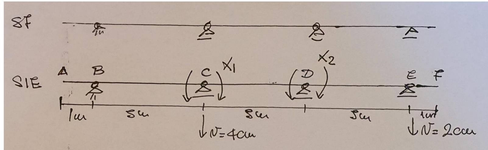
Las flexibilidades ya se calcularon en el Problema 3, cuando se calculó la viga para el caso de las cargas mecánicas. La novedad en este caso consiste en calcular los términos de carga para los descensos de apoyo. Los mismos se obtienen en base a consideraciones geométricas. También pueden calcularse mediante el TTV.
