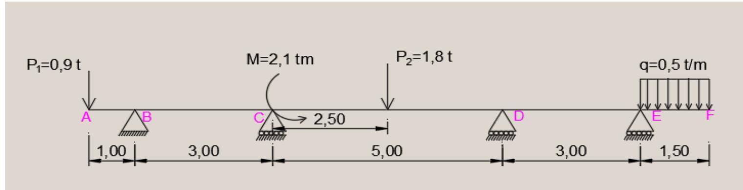
En este caso es una sola chapa. Hay cinco condiciones de vínculo, luego el  $GH = 2$ . El Sistema Fundamental y el Sistema Isostático Equivalente seleccionados son:
