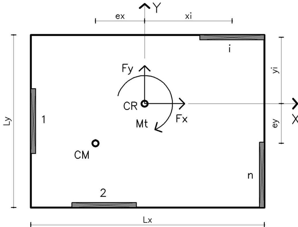
$$\begin{bmatrix} R_{xx} & 0 & 0 \\ 0 & R_{yy} & 0 \\ 0 & 0 & I_{xy} \end{bmatrix} \begin{bmatrix} X_R \\ Y_R \\ Z \end{bmatrix} = \begin{bmatrix} F_x \\ 0 \\ M_{tx} \end{bmatrix}$$
