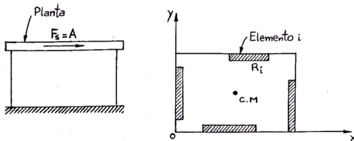
la losa es un diafragma rígido por hipótesis. Luego todos sus puntos se mueven solidariamente y lo mismo sucede con los elementos estructurales vinculados a la losa. El movimiento del sistema quedará determinado si se conoce la posición deformada del plano horizontal de la losa. Luego el problema posee 3 grados de libertad.
