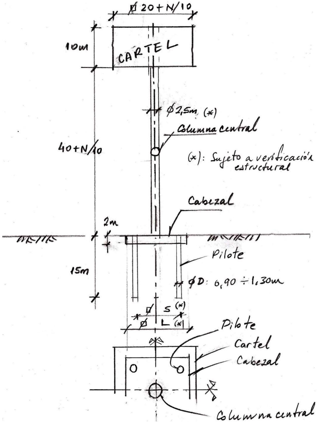
Estructura metálica y cimentación de hormigón armado.
