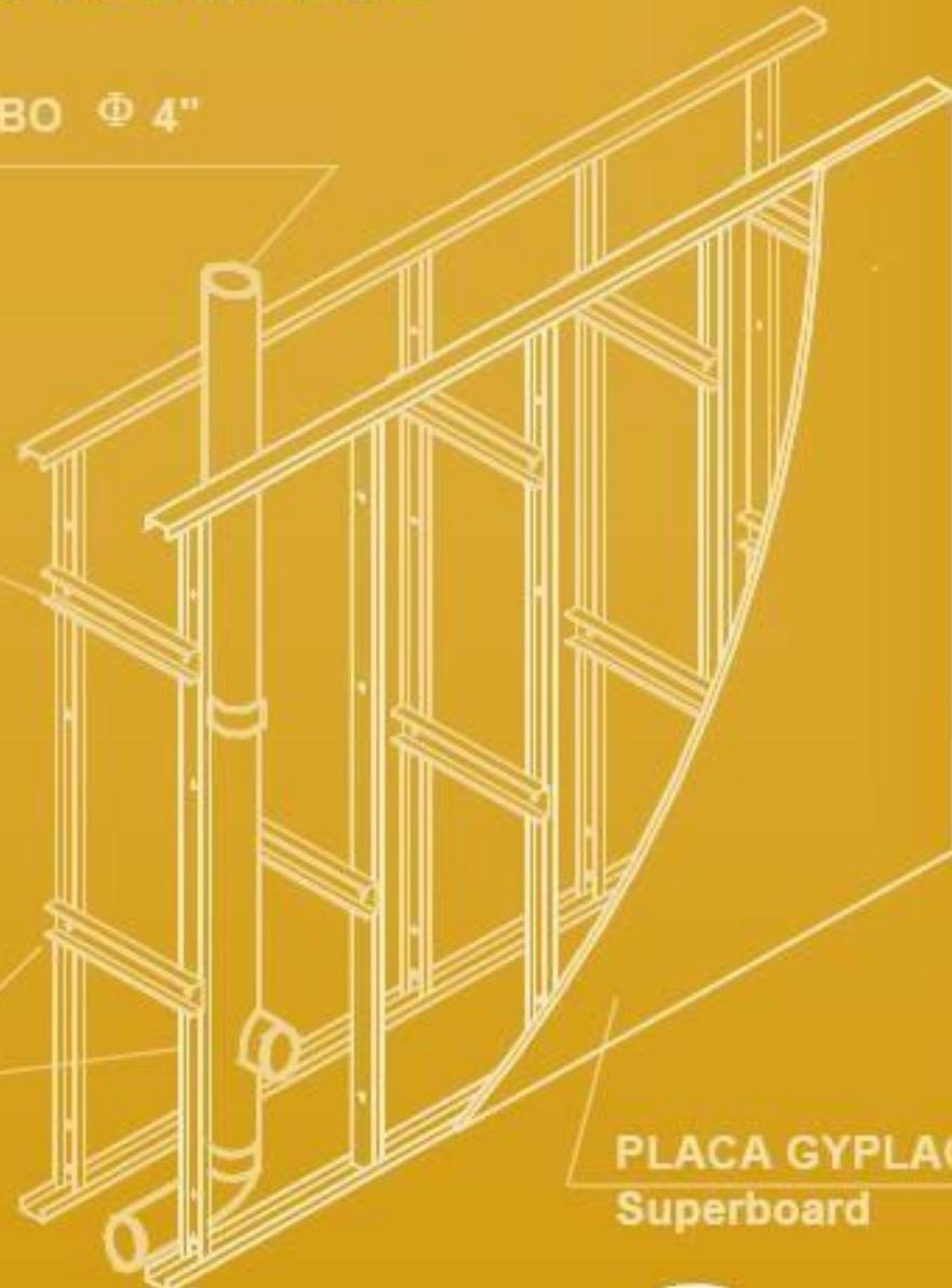
ESTRUCTURA DE MURO
