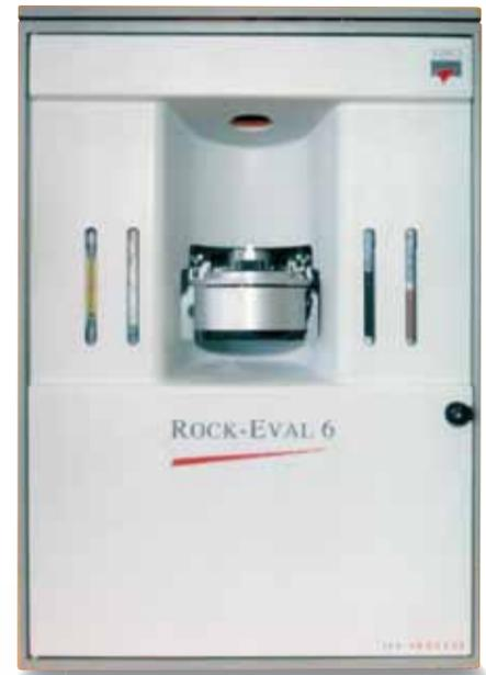
^ Pirolizador. Este analizador de pirólisis Rock-Eval 6 registra los gases liberados de la roca generadora durante un proceso de calentamiento programado. (Fotografía, cortesía de Vinci Technologies SA.)
