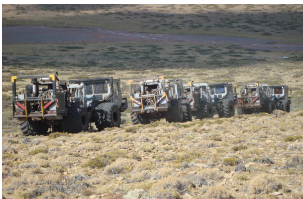
Camiones vibradores en un área a explorar
