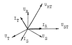
Para el tipo de carga considerada la potencia total será:  $P = W_1 + (-W_2) = 0$ . En general, cuando uno de los vatímetros (en este caso el 2), tiende a señalar en sentido contrario (lo que ocurre para  $\varphi > 60^{\circ}$ ), se invierte la conexión de uno de sus circuitos y la potencia total se obtiene por diferencia:  $P = W_1 - W_2$
