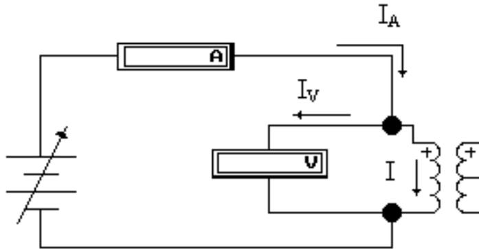
La intensidad de la corriente no debe superar el 15% de la nominal del arrollamiento. Los conductores de unión del voltímetro deben ser independientes de los del circuito serie.
