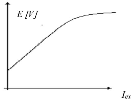
Es de esperar una curva como la de la figura. La característica no pasa por el origen de coordenadas debido a que, para  $I_{ex}=0$ , actúa el magnetismo remanente del sistema inductor; éste es suficiente para originar una f.e.m. OM; hay una zona de crecimiento rápido y proporcional a  $I_{ex}$  y, finalmente, continúa una parte sensiblemente recta pero de pendiente mucho menor.
