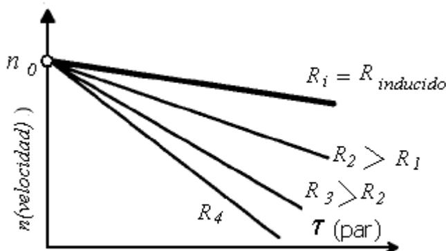
Figura 5 Variación de la resistencia de inducido
