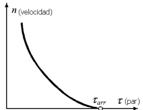
Figura 9 Curvas par-velocidad de un motor serie.
