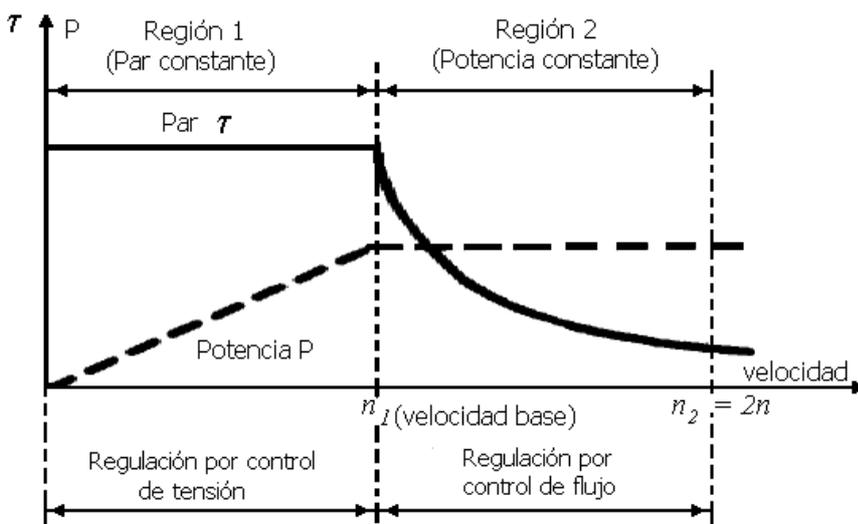
Figura 7 (c) Regulación de velocidad a potencia constante y a par constante
