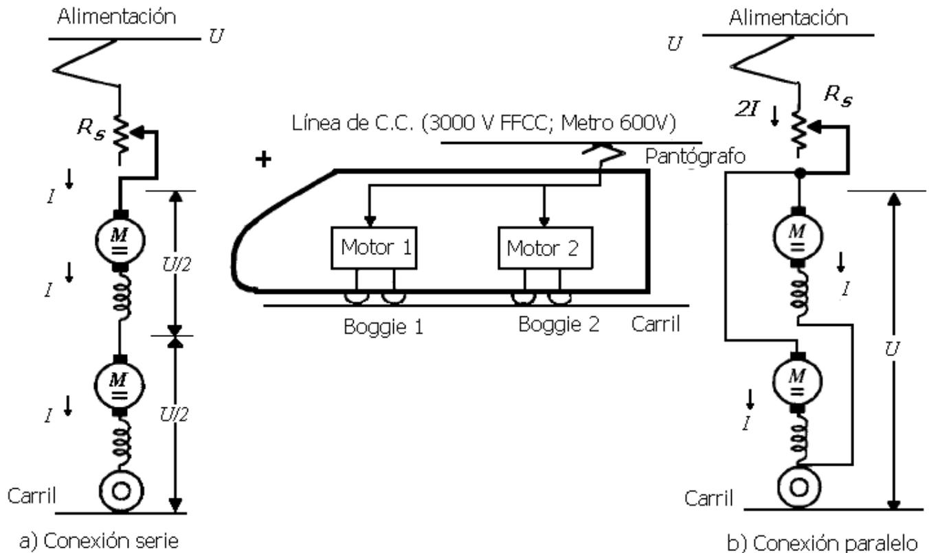
Figura 10 -Conexión en serie y en paralelo de motores serie de c.c. en tracción eléctrica
