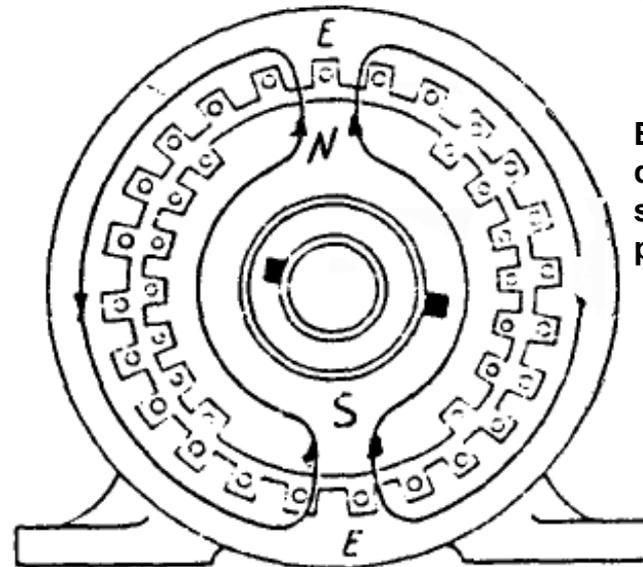
Esquema de construcción de alternadores sincrónicos con rotores de polos salientes y lisos
