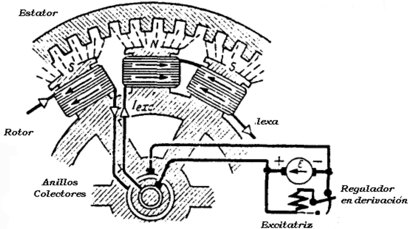
Fig. 6 Esquema de excitación de una máquina síncronica
