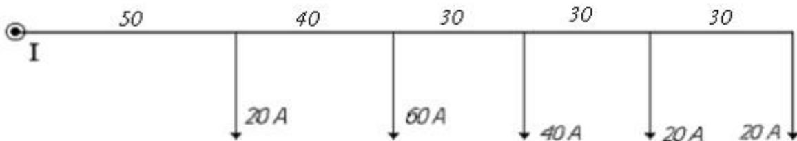
2.- En la línea subterránea bipolar representada en la Figura,  $U = 220 \text{ V}$  de cc.. Como caída de tensión puede admitirse un 2,5 %. Los receptores son lámparas de unos  $55 \text{ W}$  de consumo por término medio. ¿Qué secciones habrá que dar a la línea en el caso de ser de cobre y de aluminio, respectivamente? Suponer temperatura media anual de  $40 \text{ }^\circ\text{C}$ .
