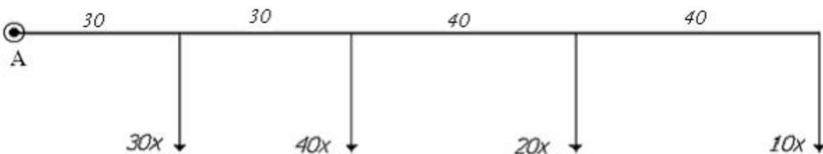
3.- Las cargas de la línea aérea unipolar representada en la Figura están dadas en Watt. La tensión en bornes de los aparatos conectados es  $U = 110 \text{ V}$ . La caída relativa de tensión no debe exceder del 4 %. El material de la línea es cobre y la temperatura media anual de  $30 \text{ }^\circ\text{C}$ . ¿Con qué sección debe construirse la línea?
