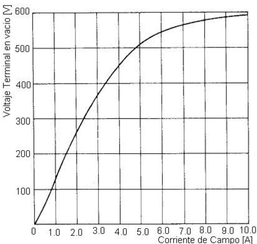
5.- Un alternador trifásico conectado en estrella, tiene una resistencia de inducido despreciable y una reactancia síncrona de  $10 \Omega$ /fase. Está acoplado a una red de potencia infinita de 11 kV, y se sabe que desarrolla una potencia con factor de potencia 0,673 inductivo, siendo el ángulo de carga de  $10^\circ$ . Calcular: a) la f.e.m. de línea producida por el generador; b) La potencia activa que suministra a la red.
