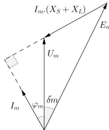
8.-Un alternador trifásico tiene una impedancia síncrona  $Z_s = 0 + j5 \Omega$  y está conectado a una red de potencia infinita de 6600 V. La excitación es tal que la f.e.m. inducida en vacío es de 6000 V. Determinar la potencia activa máxima que en estas condiciones podrá suministrar la máquina, sin que exista pérdida de estabilidad. Hallar también la corriente de inducido y el factor de potencia para dicha carga.
