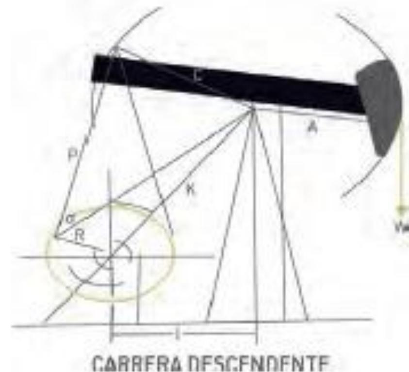
En el caso de las unidades equilibradas neumáticamente o de unidades equilibradas con contrapeso con disposición geométrica similar (Mark II), el cigüeñal y la biela están en el lado del pozo del soporte de balancín, por lo tanto: “la veloc. y acelerac. son más altas en la parte superior que en la parte inferior del recorrido del vástago”
