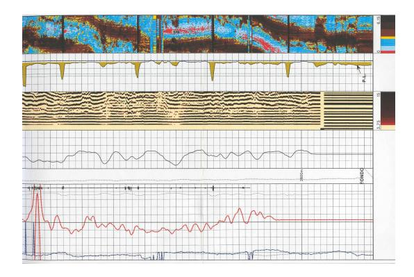
La amplitud de la onda reflejada (Primer Arribo), no es afectada por la presencia o ausencia de cemento detrás de la cañería, es, como su nombre lo indica, una imagen reflejada del pulso transmitido.
