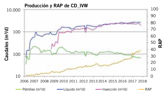
Figura 9. Historia de producción e inyección del bloque CDIVW previa a la inyección de TAP y mapa del bloque.
