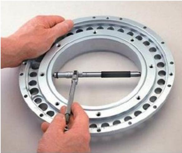
Es importante hacer estas mediciones en el menor tiempo posible, debido a que el manipuleo va transmitiendo el calor de las manos al instrumento lo que produce dilatación y pérdida de exactitud en las mediciones.
