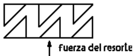
Cuando la perilla externa del trinquete se gira en sentido horario, ambos trinquetes giran juntos hasta que la fuerza de medición rebasa cierto límite y los trinquetes giran dentro de la perilla y se deslizan inútilmente, emitiendo un sonido característico de este elemento. Si giramos la perilla en sentido anti horario impide que haya deslizamiento entre los trinquetes, ya que los dientes de los mismos se bloquean sobre los flancos agudos.
