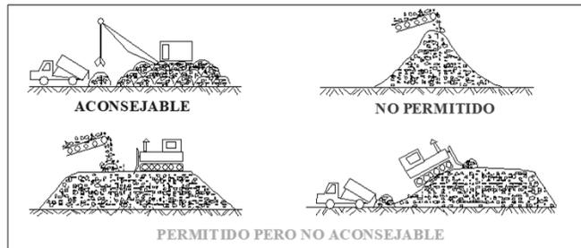
Figura 8.2 - Métodos para almacenar los agregados en pilas.
