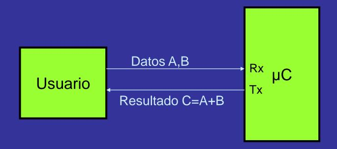
A través de Rx (receptor serie) el microcontrolador recibe los datos A y B, los suma y transmite el resultado por Tx (transmisor serie)
