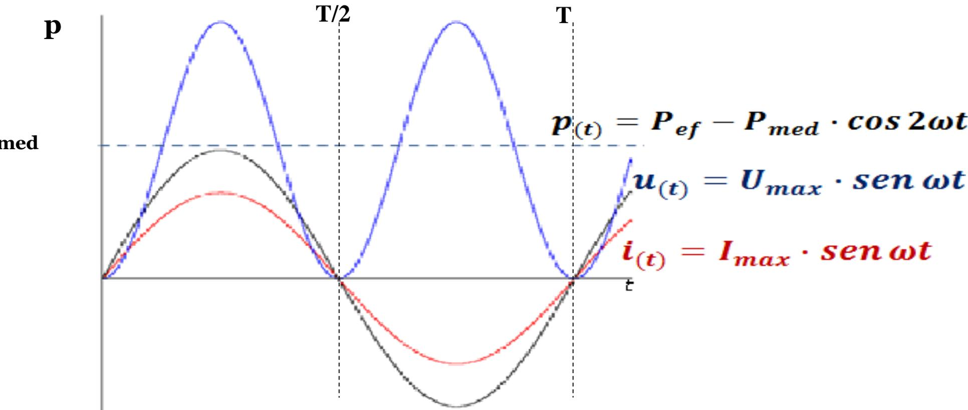
Existe una energía cedida por unidad de tiempo desde la fuente al circuito, que se disipa en la resistencia en forma de calor.
