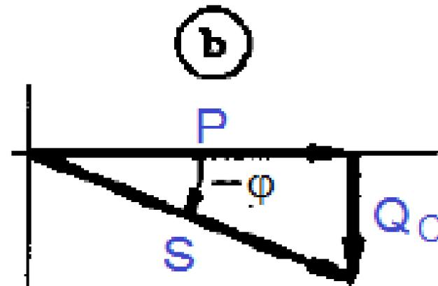
Triángulo de potencias de un circuito serie RLC:
