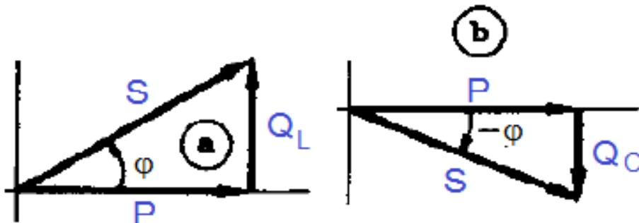
Triángulo de potencias de un circuito serie RLC:
