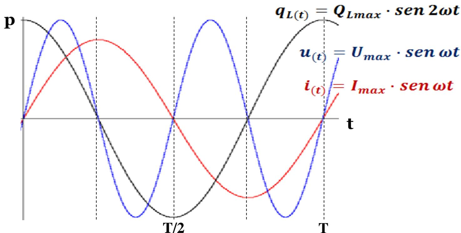
**• La potencia inductiva es una potencia reactiva que se manifiesta en un intercambio de energía entre la red y el inductor.**
