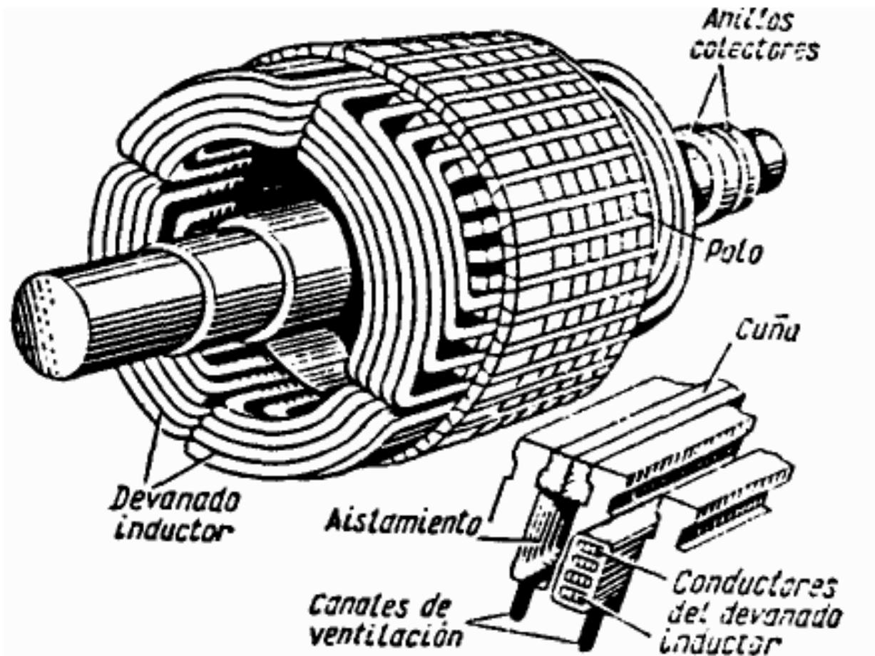
Fig. 5 Aspecto general de un rotor liso montado tetrapolar
