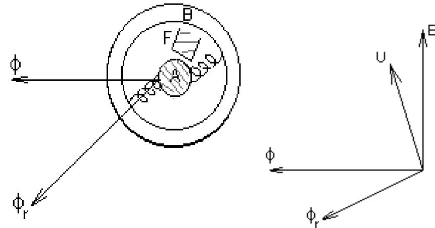
Un símil mecánico de la máquina síncrona como generador - fig. 10 – Podría representarse como un eje A (rueda polar) que gira accionado por un motor y esta ligado a una corona B (inducido) por resortes C (flujo resultante). Al hacer girar el eje, aplicando un freno F a la corona (carga de la máquina) el resorte se estira (los polos se desplazan) formando un cierto ángulo (ángulo de carga) proporcional al frenado (potencia entregada).
