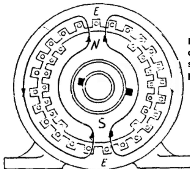
Esquema de construcción de alternadores sincrónicos con rotores de polos salientes y lisos
