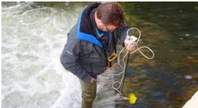
Figura 6: Medida de caudal con molinete, que a través de su rotación se calcula la velocidad.
