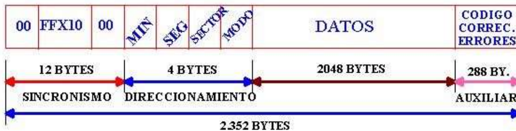
Figura III.31 - Formato de pista y sectores en discos CLV.
