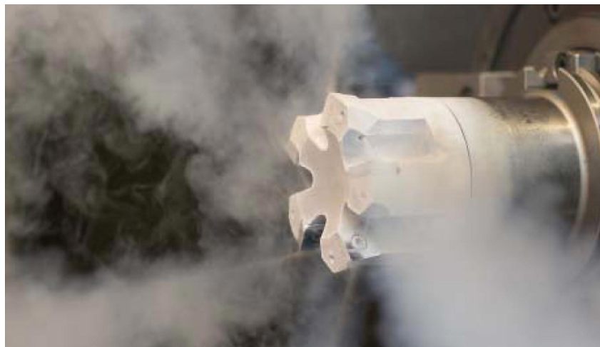
Figura 1. Refrigeración criogénica por el interior de una herramienta (SME y Okuma)
