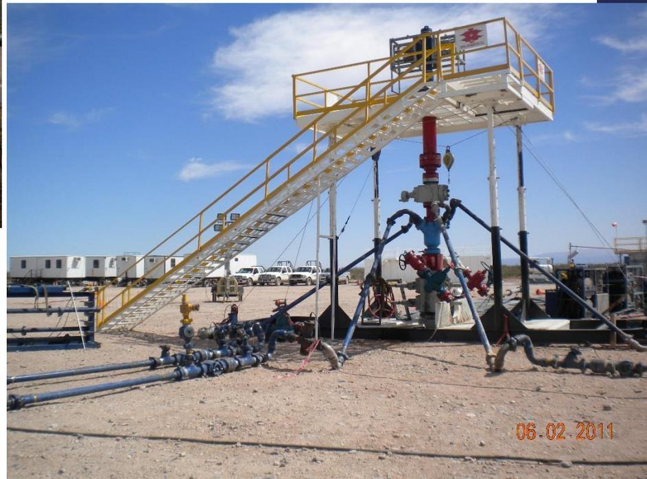
Cabezal de Fractura
