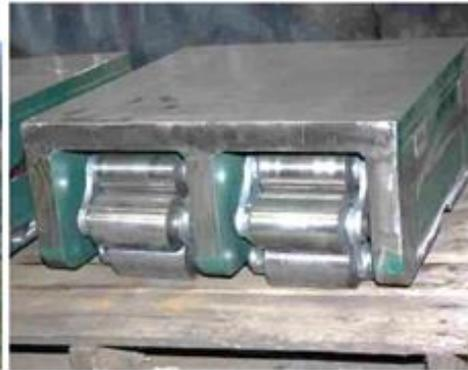
Movilización de un equipo de perforación mediante un sistema deslizando
