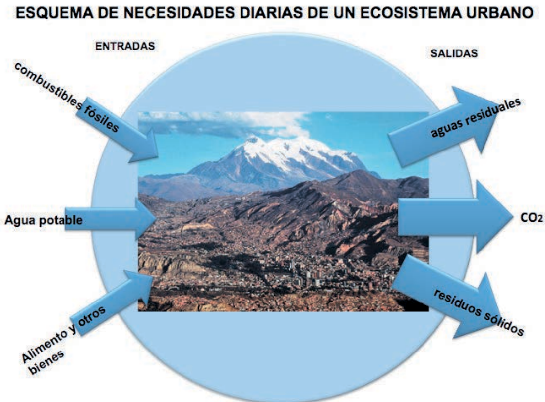
Figura 2.9 Esquema generalizado de los flujos de materia y energía de una ciudad, comparar con la figura 3.3, particularmente el tamaño y dirección de las flechas (Elaboración propia).
