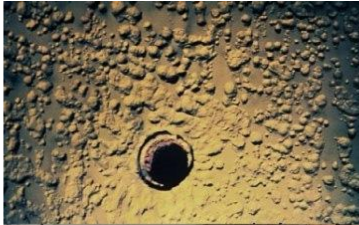
Fig. 17: Superficie afectada por la cavitación
