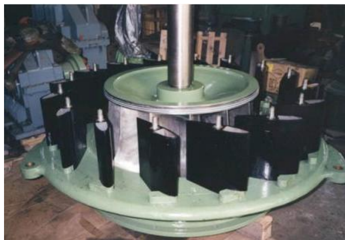
Fig. 4: Palas directrices del distribuidor
