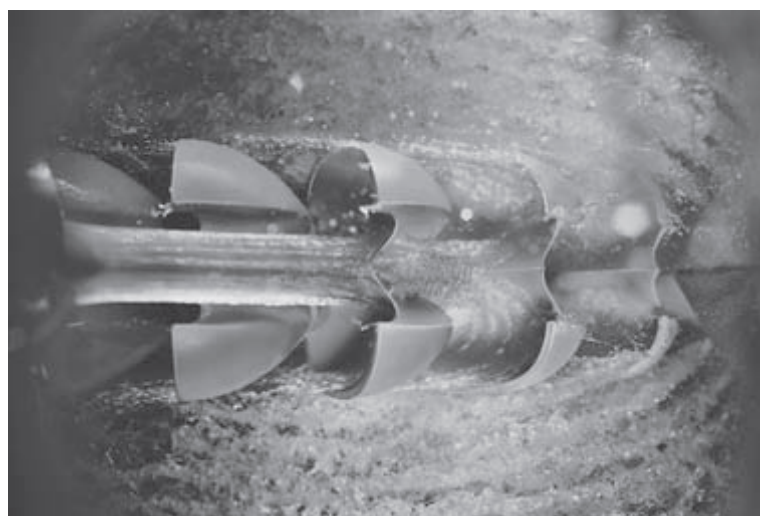
Figura 9: Vista desde el fondo de una rueda Pelton en operación que ilustra la separación y desviación del chorro de agua en el cangilón
