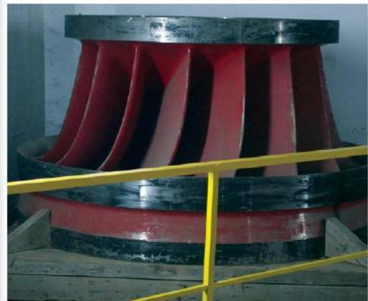
Vista de uno de los grupos generadores, vista del rodete de la turbina Francis
