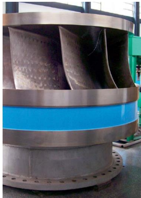
Vista de la central con los tres grupos generadores de la misma, vista del rotor de una de las turbinas Francis
