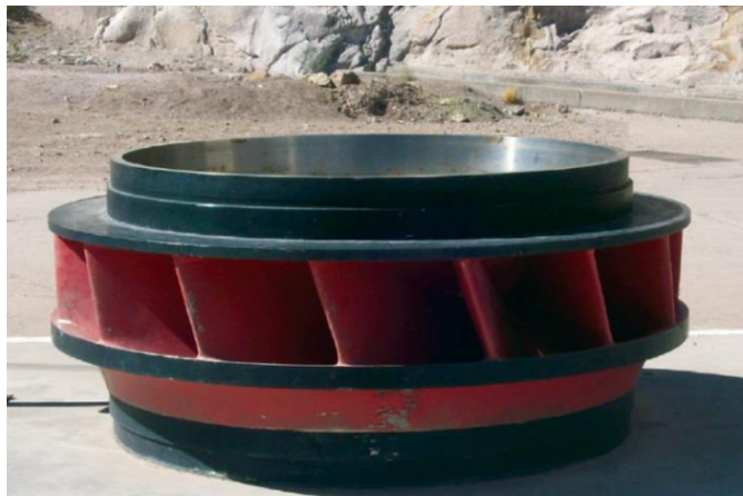
Rodete de una de las turbinas Francis de la central Nihuil II
