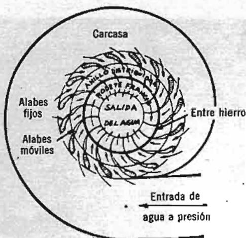
Fig. 4.5 Corte ecuatorial de una turbina Francis.
